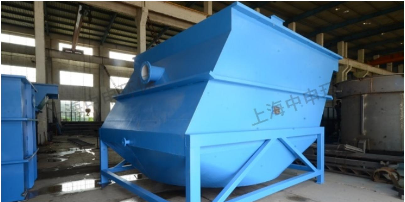
设斜管沉淀池池长为 $L$ ，池中水平流速为 $V$ ，颗粒沉速为 $u_0$ 。在理想状态下， $L/H/V/u_0$  可见 $L$ 与 $V$ 值不变时，池身越浅，可被去除的悬浮物颗粒越小。若用水平隔板，将 $H$ 分成3层，每层层深为 $H/3$ ，在 $u_0$ 与 $v$ 不变的条件下，只需 $L/3$ 就可以将 $u_0$ 的颗粒去除。也即总容积可减少到原来的 $1/3$ 。如果池长不变，由于池深为 $H/3$ ，则水平流速可增加的 $3V$ 仍能将沉速为 $u_0$ 的颗粒除去，也即处理能力提高倍。同时将沉淀池分成 $n$ 层就可以把处理能力提高 $n$ 倍。这就是20世纪初，哈真·Hazen提出的浅池理论。而在沉淀池有效容积一定的条件下，增加沉淀面积，可使颗粒去除率提高。根据这一理论，过去曾经把普通平流式沉淀池改建成多层多格的池子，使沉淀面积增加。但由于排泥问题没有得到解决，因此无法推广。为解决排泥问题，斜板沉淀池发展起来，浅池理论才得到实际应用。
